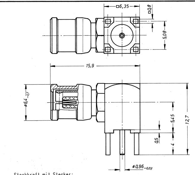
Steckkraft mit Stecker: Mating force with plug: Min. 3.5N, max. 7N
