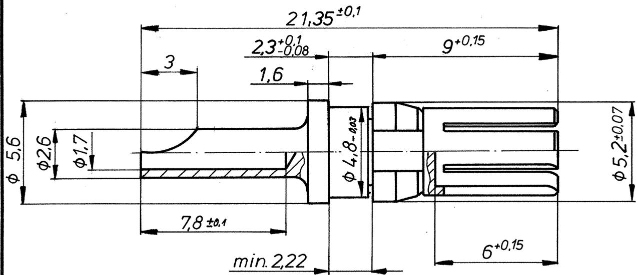
Anmerkung: In der 12-stelligen Bestell-Nr. ist mit der 12-ten Zahl die Oberfläche mit „1“ gleich Ind. Ausführung und mit „2“ gleich VG-Ausführung anzugeben.
