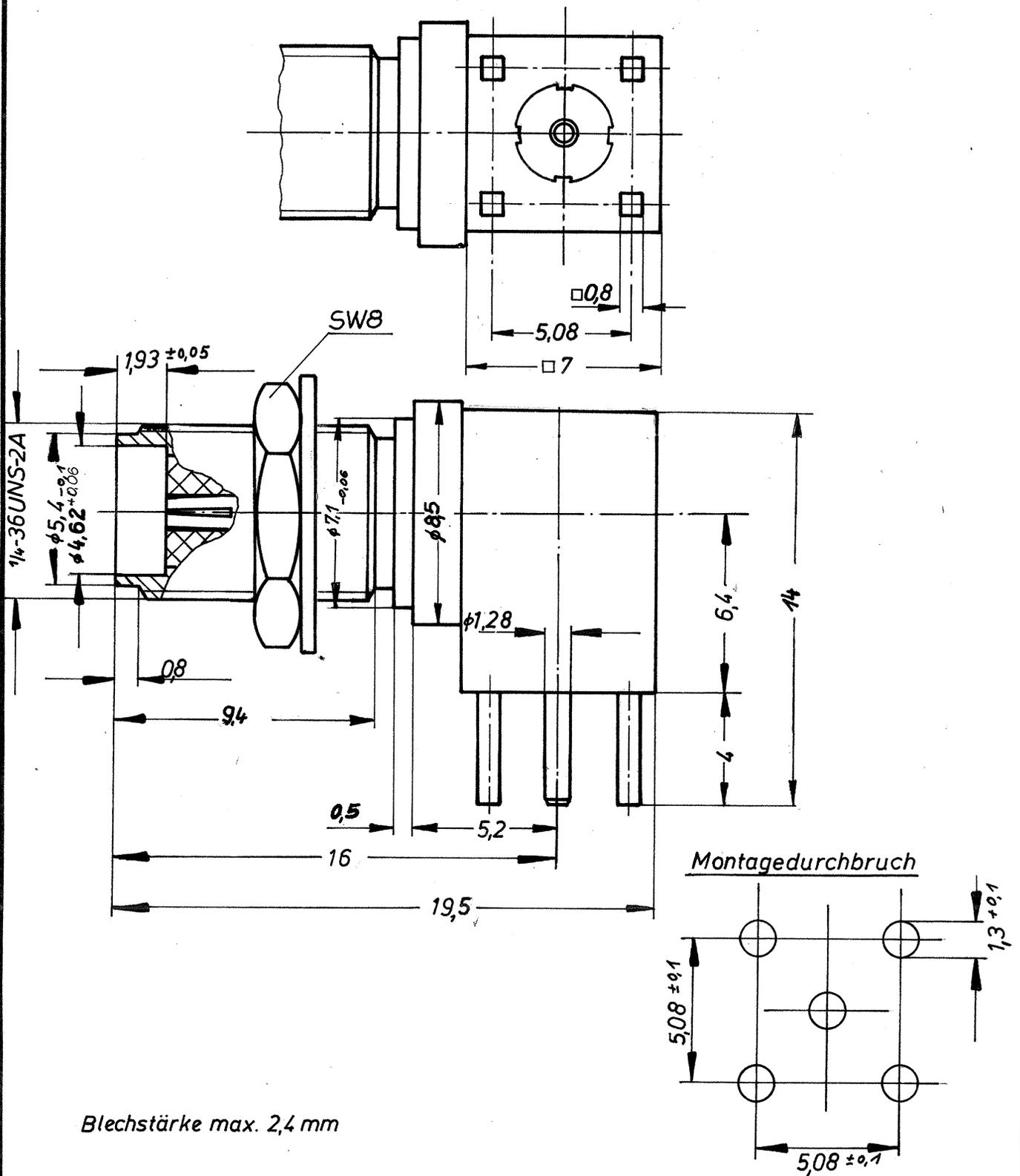
Anmerkung: In der 12-stelligen Bestell-Nr. ist mit der 12-ten Zahl die Oberfläche mit „1“ gleich Industrie-Ausführung, „2“ gleich VG-Ausführung, „8“ gleich hauch-rhodinierte Ausführung angegeben.
